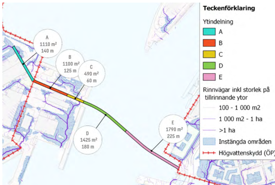
Figur 81 Schematisk bild som visar vilka ytor som använts för beräkning av avrinning från gång- och cykelbron. (Sweco,2025)
