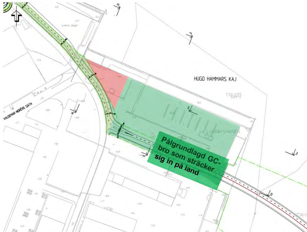
Figur 86 Områdesmarkeringar i plan med redovisning av gång- och cykelvägens placering där grön streckad linje visar planområdet. Röd markering visar område där inga belastningar eller markhöjningar kan påföras marken för att stabilitetskraven ska uppnås. Inom den mörkgröna områdesmarkeringen medges en variabel last från gång- och cykelvägen samt en markhöjning om 0,5 meter. Inom den ljusgröna områdesmarkeringen kan gång- och cykelvägen placeras utan geoteknisk förstärkning med hänsyn till stabilitetsförhållandena. Gång- och cykelvägen kan dock inte placeras 0,5 meter ovan befintlig mark längs med hela sträckningen utan att ytterligare geotekniska åtgärder utförs (PM Geoteknik, Sweco, 2025).
