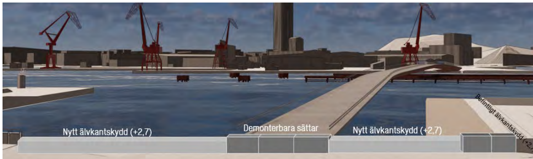
Figur 88 Principiell skiss som visar hur gång- och cykelbrons öppning vid högvattenhändelser kan stängas av manuellt.
